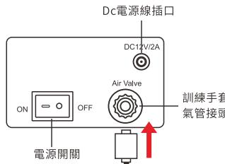
**注：訓練手套接入口需將氣管接頭順時針旋轉擰緊到主機對應接口。**
